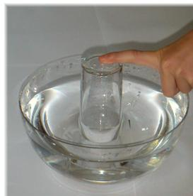
*Natürlich hast Du es herausgefunden! Das Wasser steigt nicht in das Glas. Die Luft im Glas macht das unmöglich. Luft besteht nämlich nicht aus Nichts, sondern aus Materie! Und so ein Ding, was aus Materie besteht, nennen wir Körper. Luft ist eben auch ein Körper und wo schon ein Körper ist, kann nie ein zweiter Körper sein.*
